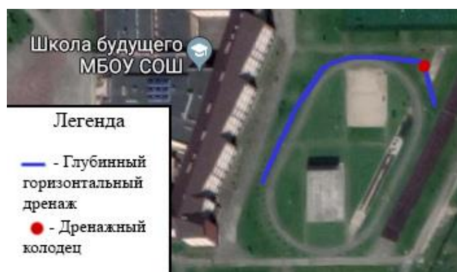
Рис. 15 Решение №4 – глубинный горизонтальный дренаж радиального расположения.
