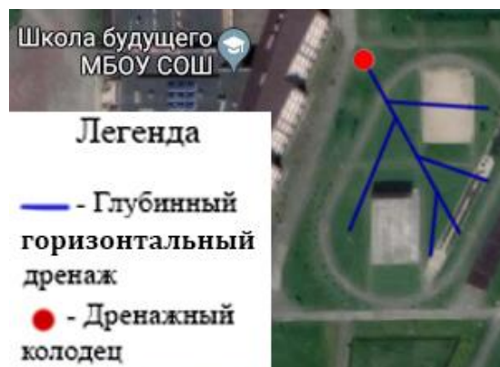
Рис. 13 Решение №2- глубинный горизонтальный дренаж ветвистого расположения.
