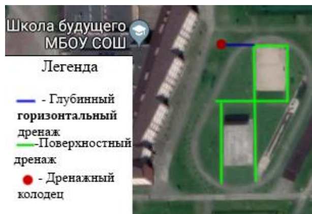
Рис. 14 Решение №3- поверхностный дренаж.
