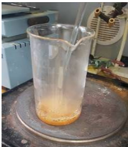
Рис.13. Процесс окисления пробы перекисью водорода.
