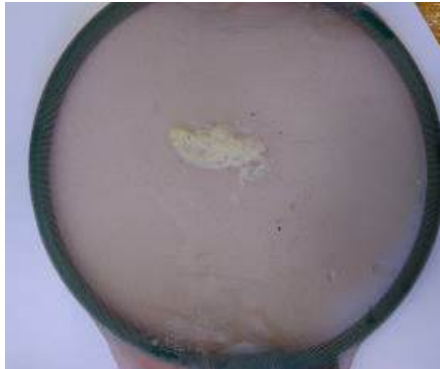
Рис.2. Микропластик на капроновом сите
