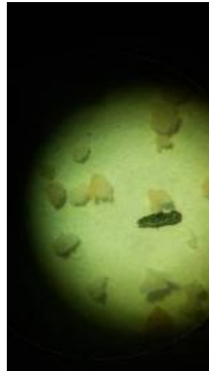
Рис.7. Частицы полиэтилена под микроскопом (черная полоска соответствует 1 мм)
