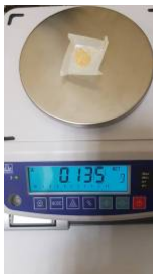
Рис. 6. Результат взвешивания полиэтилена содержащегося в скрабе
